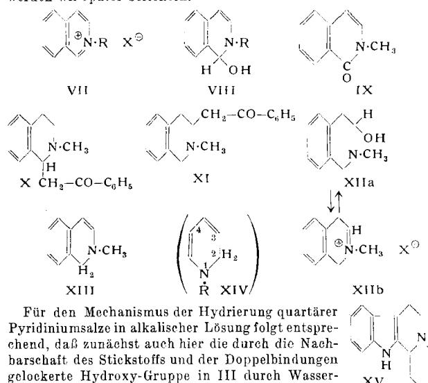
Für den Mechanismus der Hydrierung quartärer Pyridiniumsalze in alkalischer Lösung folgt entsprechend, daß zunächst auch hier die durch die Nachbarschaft des Stickstoffs und der Doppelbindungen gelockerte Hydroxy-Gruppe in III durch Wasserstoff ersetzt wird unter Bildung des unter unseren Bedingungen nicht fassbaren Zwischenprodukts XIV, das dann an der 3,4-ständigen Doppelbindung weiter hydriert wird zu der Anhydrobase IV, die schließlich in Ia bzw. Ib bzw. in VI übergeht.
